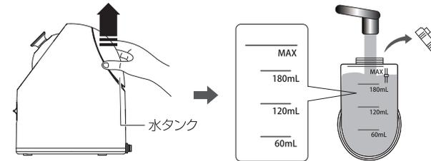
3. キャップを閉めた水タンクを、本体に確実にセットします。
