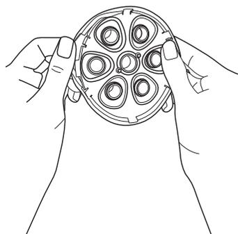
5 うすめた中性洗剤でアタッチメントと枠についている汚れを落とした後、水で洗い流す。
