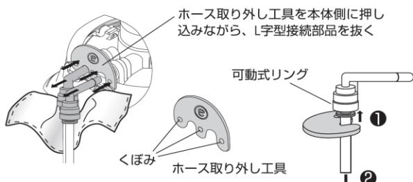
ホース取り外し工具がない場合や、ホース取り外し工具でうまくできない場合は、可動式リングの両端を指で均等に強く押しながら、L字型接続部品を引き抜いてください。
