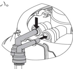
◆ブラケット差し込み口には、大と小があります。大に太い方のL字型接続部品を、小に細い方のL字型接続部品を差し込んでください。
