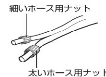
2 細いホースを外側の差し込み口に、太いホースを中心の差し込み口に差し込みます。
