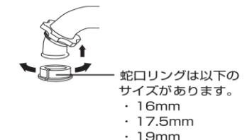
3 切り替えバルブを下から水平に当て、蛇口取り付けキャップを回して締め付けてください。
