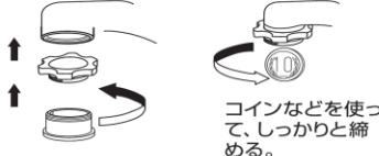
3 切り替えバルブを下から水平に当て、蛇口取り付けキャップを回して締め付けてください。
