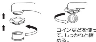
3 切り替えバルブを下から水平に当て、蛇口取り付けキャップを回して締め付けてください。
